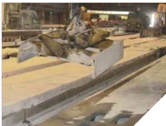
Fig. 4: Hijsen van voorgespannen kanaalplaatvloer.
